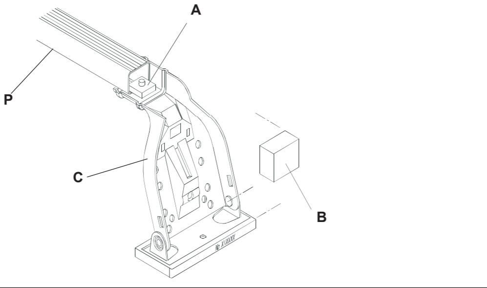
**D** Die Traverse (P) auf den Fuß (C) schieben. Wichtig! Beachte, daß die Vierkantmutter (A) ordnungsgemäß in die Traverse eingeführt wird. Endverschluß (B) auf die Traverse montieren.
