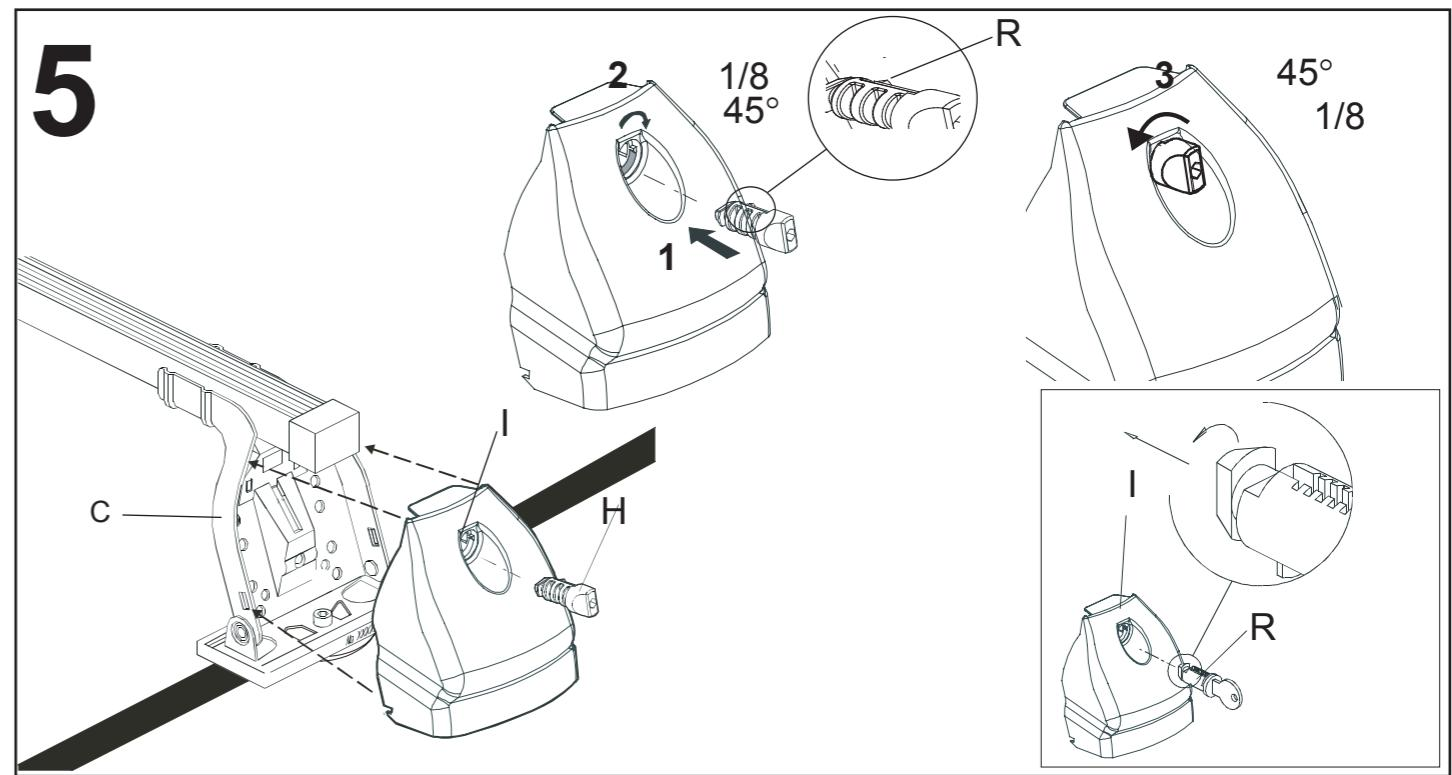
**D** Den Blindknopf (H) mit dem Haken (R) wie in Figur dargestellt, halten. Den Blindknopf in das Schloßloch der Schutzkappe (I) einführen. Den Blindknopf 1/8 Drehung im Uhrzeigersinn drehen und festdrücken. Dann 1/8 Drehung entgegengesetzt dem Uhrzeigersinn drehen um einen festen Sitz zu sichern. Den Sitz des Blindknopfes ordentlich kontrollieren.
