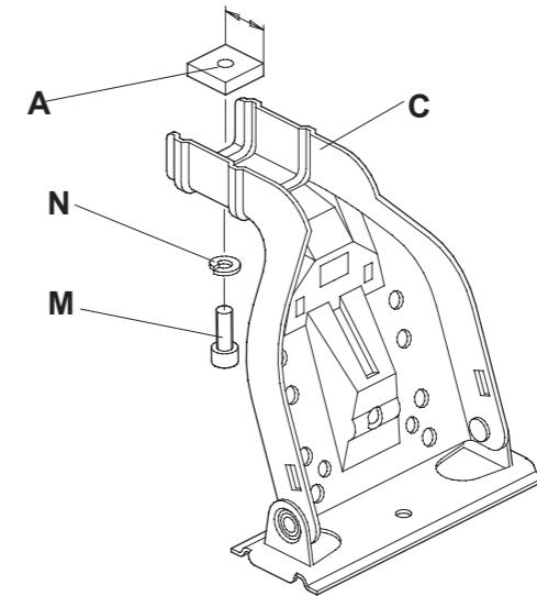
**D** Innensechkantschraube (M) und Federscheibe (N) lose in dem oberen Loch des Fußes (C) mit der Vierkantmutter (A) befestigen.
