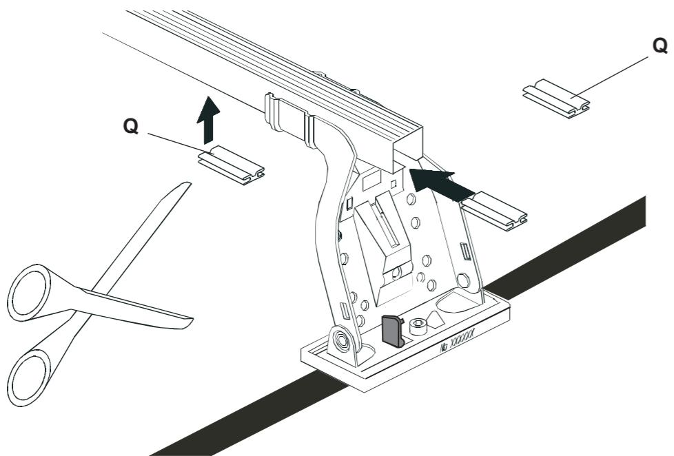
**D** Um eventuelle Windgeräusche zu vermeiden, benutzen Sie bitte den beigelegten Schlitzschutz (Q). Eine passende Länge zuschneiden und dann den Schlitz in der Traverse damit abdecken. Siehe Figur.
