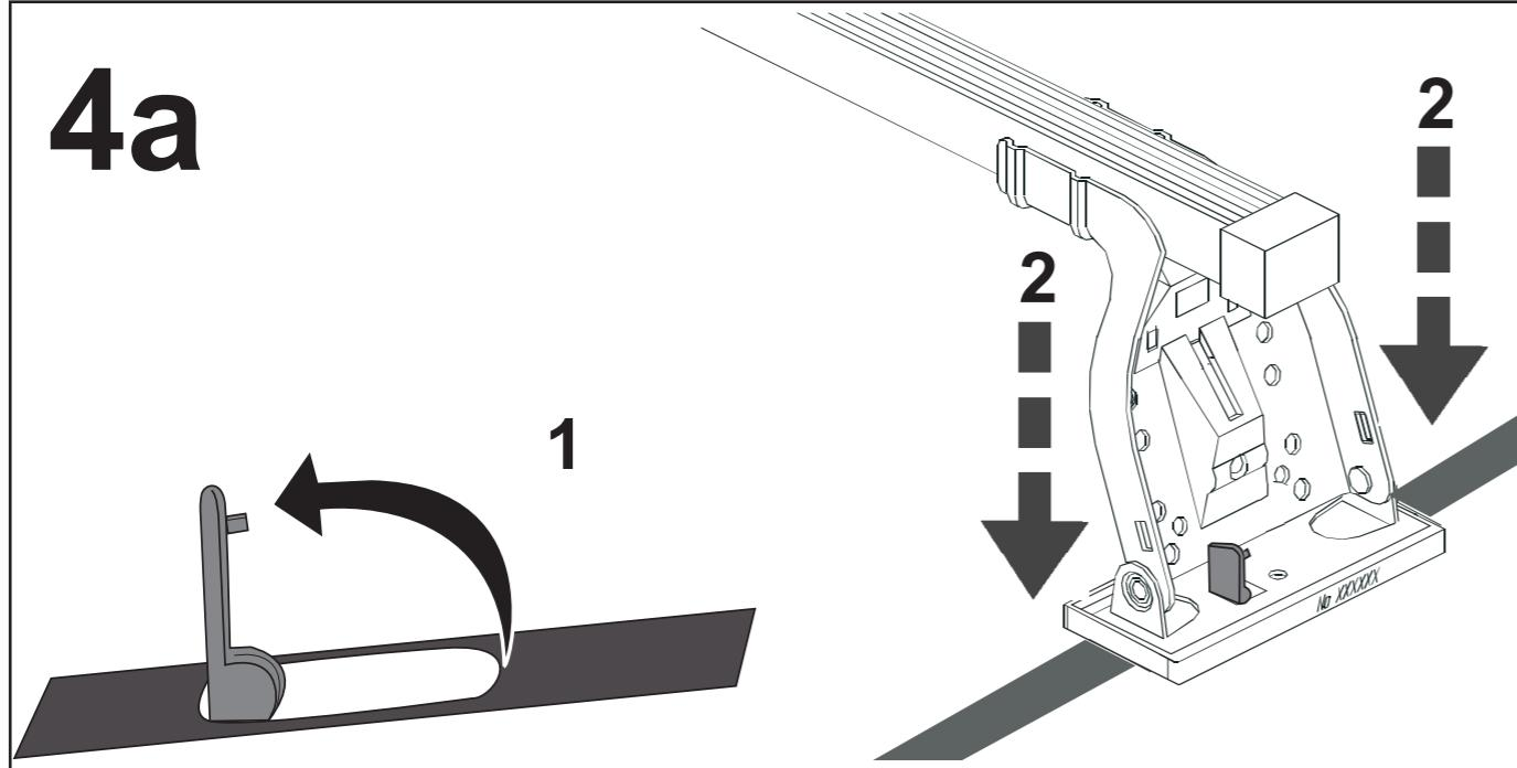
**D** Das Autodach von Staub und Schmutz reinigen. **4a:** Den Lastenträger auf das Autodach stellen und die Füße über die Schraubenlöcher des Daches einpassen und diese mit der Innensechskantschraube (D) und Innensechskantschlüssel (O) festschrauben, so daß sie ordentlich festsetzen. **4b:** Die Traverse zentrieren. Die Innensechskantschraube (M) mittels des Innensechskantschlüssels (O) fest anziehen. Kontrolliere, daß der Lastenträger ordentlich festsetzt. Siehe Anmerkungen \*.
