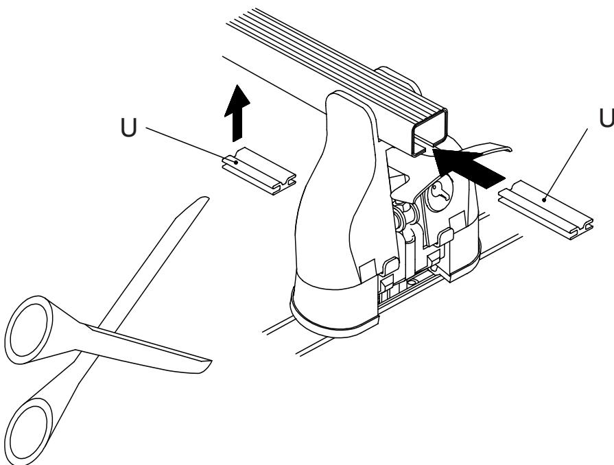
D Um eventuelle Windgeräusche zu vermeiden, benutzen Sie bitte den beigefügten Schlitzschutz (U). Eine passende Länge zuscheiden und dann den Schlitz in der Traverse damit abdecken. Siehe Figur.
