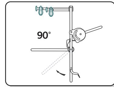
**sw.** Placera den hopmonterade cykelhållaren på en ren yta enligt bilden. Lossa de två låsningarna och vrid stödarmarna för cykeln 90° till låsningsläget. Snabblösningen skall känna fast både vid öppning och stängning. Spänningen kan justeras genom att handtagen för låsningen lossas och vrids medurs.
