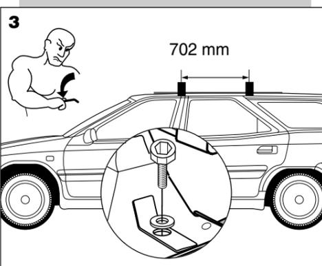
**3** Positionner les barres en respectant le schéma de montage. Serrer fortement les vis (5 Nm).
