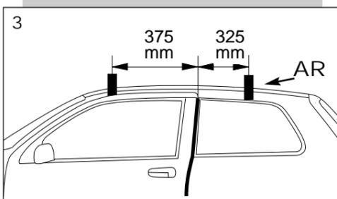
**3** Positionner les barres en respectant le schéma de montage.
