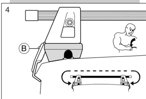
**4** Serrer alternativement les vis **B** (5 Nm).
