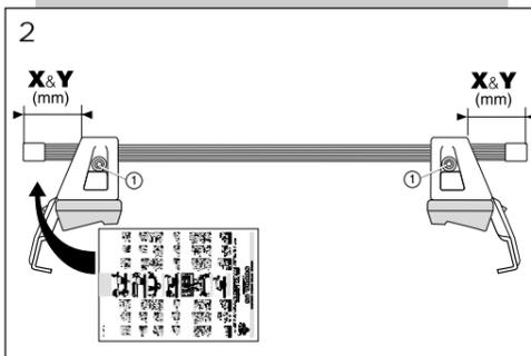
**2** Equilibrer le débordement des barres en réglant l'écartement entre les sabots à **X = 109 mm** à l'avant et à **Y= 111 mm** l'arrière. Serrer fortement les vis ① (6 Nm).
