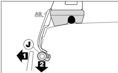
● Entrouvrir les vitres latérales, dégager le joint **J** vers le bas, puis effectuer le montage suivant 1 et 2.
