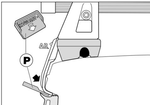
● Effectuer le montage suivant le schéma 1 et 2 en vous aidant de la plaquette **P** pour introduire la contre-patte **AR**, puis retirer la plaquette afin de bien plaquer la contre-patte.
